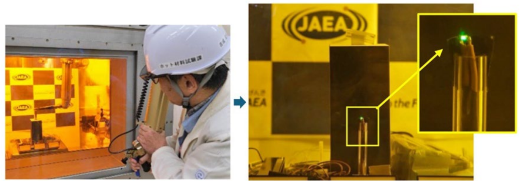
(a) 遠隔操作で Am 封入ピンを挿入 (b) 熱電変換デバイスの起電力で LED 発光
